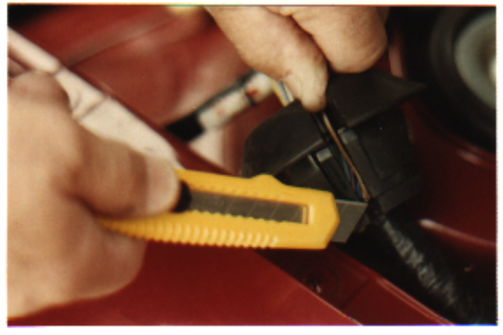
Fig. 9 Firewall Grommet Modification
