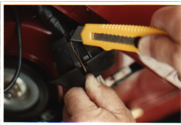
Fig. 9 Firewall Grommet Modification
